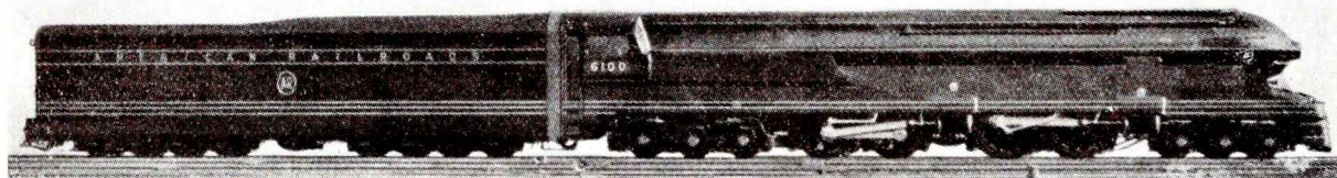
Pennsylvania Railroads første lokomotiv. — Drivhjulsdiam. 2134 mm. Lokomotivv. 276 t.
